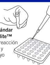
Utilice 5 µl del **Estándar Molecular Helix Elite™** diluido para cada reacción de control positivo y ejecución del ensayo de acuerdo con el protocolo apropiado para el ensayo molecular que se utiliza.
