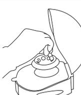
Realice un centrifugado breve para asegurarse de que todo el líquido esté en la parte inferior del tubo.
