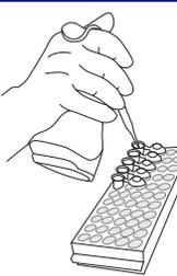
Divida en alícuotas los 10 µl del **Estándar Molecular** sintético **Helix Elite™** rehidratado en 5 nuevos tubos de microcentrifuga etiquetados.
