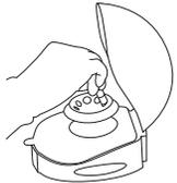
Abra la bolsa de aluminio y centrifugue el tubo del **Estándar Molecular** sintético **Helix Elite™** antes de abrir el tubo para evitar la pérdida del material seco.
